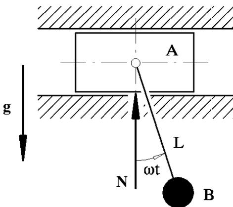
Der Körper A mit dem Gewicht  $G_1$  bewegt sich in einer glatten Führung. Im Schwerpunkt von A ist das Pendel B vom Gewicht  $G_2$  und der Pendellänge  $L$  befestigt. Die Pendelstange ist masselos und dreht sich mit der konstanten Drehgeschwindigkeit  $\omega$ .
