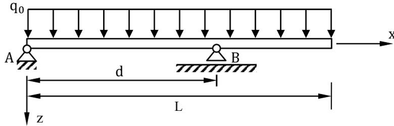
a) Zur Berechnung der Lagerreaktionen soll die Streckenlast durch eine äquivalente Einzelkraft  $R$  ersetzt werden. Geben Sie den Betrag und die  $x$ -Koordinate des Angriffspunkts von  $R$  an.
