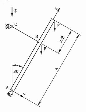
a) Schneiden Sie den Balken frei, zeichnen Sie in die Freischnittskizze alle wirkenden Kräfte und Momente ein und benennen Sie diese.
