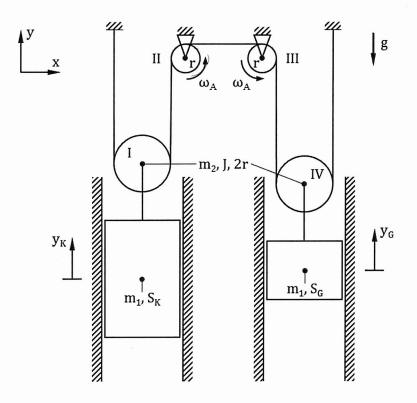
a) Wie viele Freiheitsgrade besitzt das ebene System bei ausgeschaltetem Antrieb?
