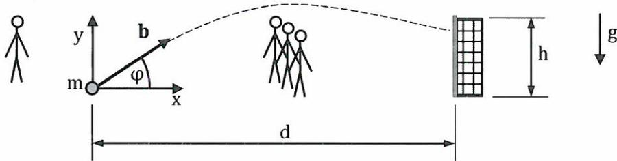
Der Ball wird als Massepunkt modelliert (Masse  $m$ ) und der Luftwiderstand wird vernachlässigt. Durch den Schuss erfährt der Ball zu Beginn (bis zum Zeitpunkt  $t_1$ ) folgende parabelförmige Beschleunigung  $a_b$  in Richtung  $\mathbf{b}$ .
