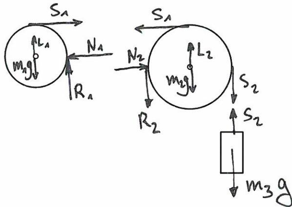
b) Stellen Sie die Impuls- und Drallsätze für die beiden Zylinder sowie den Impulssatz in vertikaler Richtung für die Masse  $m_3$  auf. Verwenden Sie die Koordinaten  $\varphi_1, \varphi_2$  und  $x_3$ .
