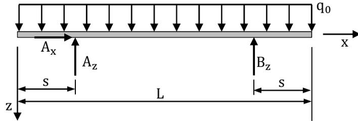
a) Berechnen Sie die aus der Streckenlast resultierende äquivalente Einzelkraft zur Ermittlung der Lagerkräfte.
