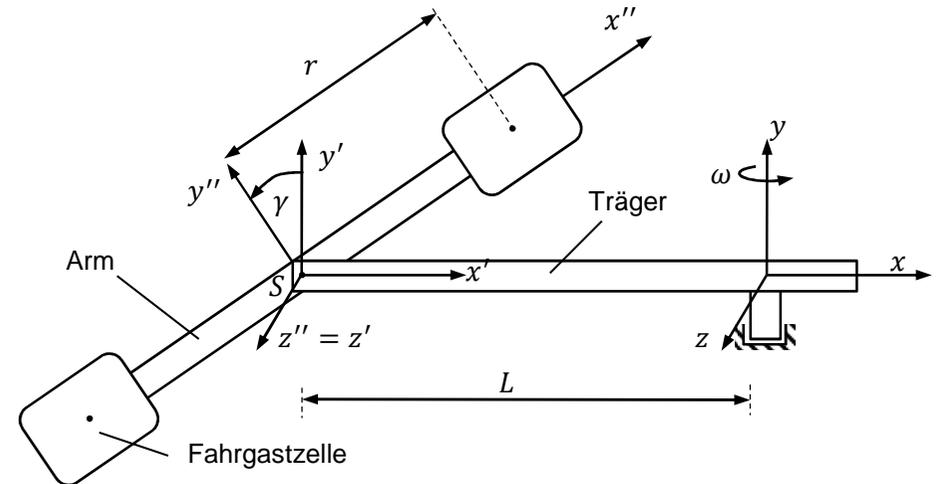
a) Geben Sie den Trägheitstensor von Fahrgastzellen und Arm bezüglich des Schwerpunkts  $S$  an. Stellen Sie den Trägheitstensor im Koordinatensystem  $K''$  dar.
