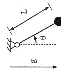
Ein mathematisches Pendel ist gegeben. An einer masselosen Pendelstange (Länge L) ist eine Punktmasse (Masse m) angebracht. Der Ausschlag des Pendels wird durch den Winkel  $\theta$  beschrieben. Die Erdbeschleunigung  $g$  wirkt wie eingezeichnet. Das Pendel wird aus der Ruhe mit Anfangsauslenkung  $\theta(0)=\theta_0$  losgelassen.
