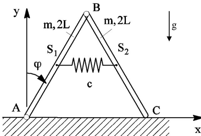
Die homogenen Stäbe AB und BC (Länge  $2L$  und Masse  $m$ ) sind bei A in einem Drehgelenk gelagert und bei B gelenkig miteinander verbunden. Das Stabende C gleitet reibungsfrei auf der horizontalen Unterlage.
