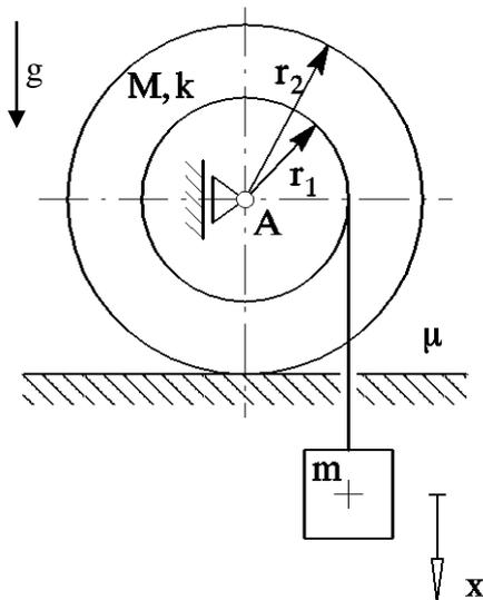
Auf einer ebenen Unterlage liegt eine Walze mit starr verbundener Seiltrommel (Gesamtmasse  $M$ , Trägheitsradius  $k$ , Walzenradius  $r_2$ , Trommelradius  $r_1$ ). Die Drehachse  $A$  ist vertikal verschieblich. Um die Seiltrommel ist ein Seil geschlungen, an dem die Masse  $m$  hängt. Der Gleitreibungskoeffizient zwischen Walze und Ebene ist  $\mu < \mu_0$ .
