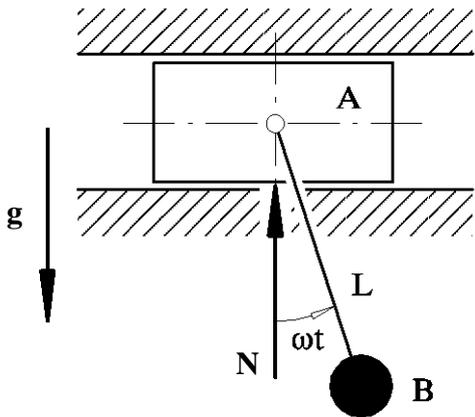
Der Körper A mit dem Gewicht  $G_1$  bewegt sich in einer glatten Führung. Im Schwerpunkt von A ist das Pendel B vom Gewicht  $G_2$  und der Pendellänge  $L$  befestigt. Die Pendelstange ist masselos und dreht sich mit der konstanten Drehgeschwindigkeit  $\omega$ .
