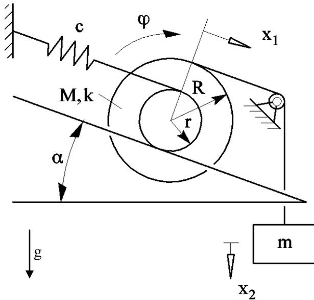
Eine Kabelrolle mit der Masse  $M$  und dem Trägheitsradius  $k$  liegt auf einem geneigten Schienenpaar. Um die Trommel (Radius  $R$ ) ist ein Seil geschlungen, dessen freies Ende über eine masselose, reibungsfrei gelagerte Umlenkrolle mit einem Gewicht (Masse  $m$ ) verbunden ist.
