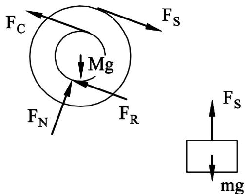
e) Warum ist in diesem Fall die Seilkraft zwischen Kabelrolle und Umlenkrolle als auch zwischen Umlenkrolle und Gewicht betragsmäßig gleich?
