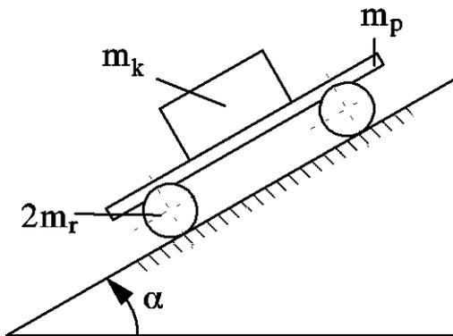
Jeder Radsatz besteht aus zwei Rädern (homogene Vollscheiben, Masse je Vollscheibe  $m_r$ , Radius  $R$ ), die durch eine masselose Achse verbunden sind. Für die Coulombsche Reibung zwischen Kiste und Platte ist der Reibungswinkel  $\rho = 10^\circ$ . Die Verhältnisse der Massen sind  $m_p : m_k : m_r = 3 : 2 : 1$ .
