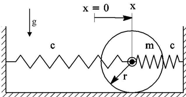
Ein Rad (Masse  $m$ , Radius  $r$ , Trägheitsradius  $k = r/\sqrt{2}$ ) rollt auf einer rauhen horizontalen Ebene (Haftreibungskoeffizient  $\mu_0$ ). Seine Achse ist durch zwei gleiche Federn (Federkonstante  $c$ ) gefesselt. Die Auslenkung der Achse aus der Gleichgewichtslage heiÙe  $x$ .
