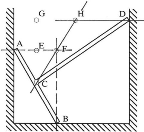
Die Stäbe AB und CD sind bei C durch ein Gelenk verbunden und gleiten in einer rechteckigen Vertiefung mit glatten Seitenwänden.
