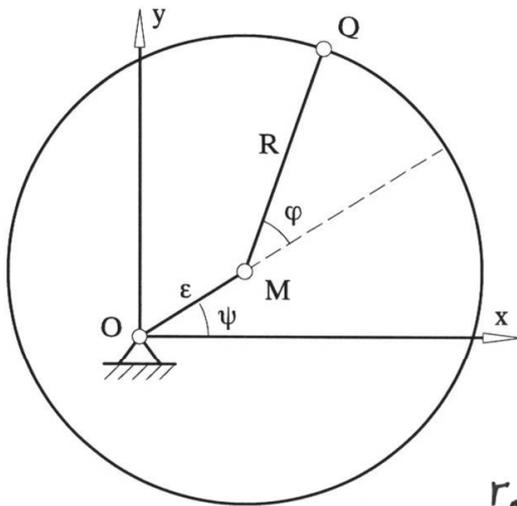
Eine exzentrisch gelagerte Kreisscheibe drehe sich in der  $x, y$ -Ebene mit der Winkelgeschwindigkeit  $\omega = \dot{\psi}$  um die  $z$ -Achse. Die Lage des Punktes  $Q$  der Scheibe sei durch den Winkel  $\varphi$  zwischen  $OM$  und  $MQ$  festgelegt.
