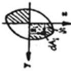
Fläche 3 :  $I_{yz} = 0$ . Koordinatensystem ist Hauptachsensystem.
