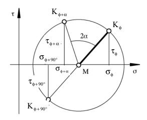
Kennt man diesen Kreis und die Spannungen  $\sigma_{\phi}$ ,  $\tau_{\phi}$  zu einem Schnittwinkel  $\phi$ , so erhält man die zum Schnittwinkel  $\phi + \alpha$  gehörenden Spannungen  $\sigma_{\phi + \alpha}$ ,  $\tau_{\phi + \alpha}$ , indem man  $K_{\phi}$  um M um den Winkel  $2\alpha$  gegen den Uhrzeiger dreht, also gleichsinnig mit der Drehung der Schnittnormalen. Daher liegen je zwei zu aufeinander senkrechten Schnittrichtungen gehörende Punkte  $K_{\phi}$ ,
