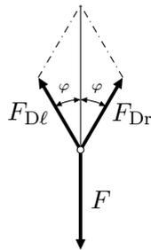
In einem ersten Schritt wird die Kraft  $F_B$  ermittelt. Aus dem Gleichgewicht von Balken 3 folgt  $F_B = F_{D\ell}$ . Somit ergibt das Gleichgewicht an Knoten D
