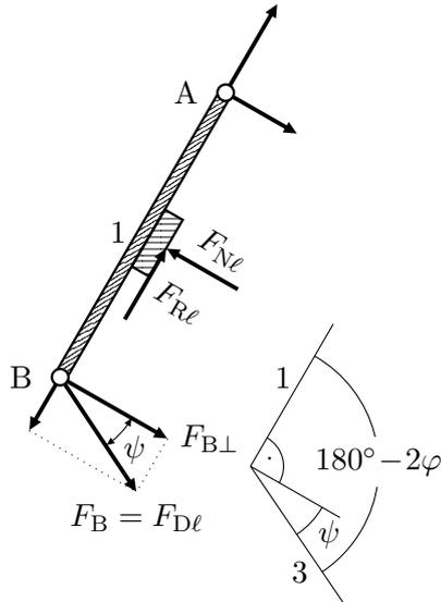
Für die Komponente  $F_{B\perp}$  der Kraft  $F_B$  in Normalenrichtung zur Balkenachse 1 gilt
