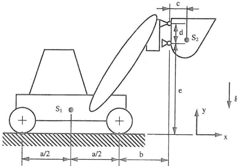
a) Schneiden Sie die Körper frei, zeichnen Sie alle angreifenden Kräfte ein und bezeichnen Sie diese.
