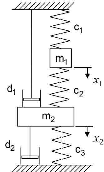
**Aufgabe 19:** Für das nebenstehende Schwingungssystem, welches aus zwei Körpern (Massen  $m$  und  $2m$ ) und drei Federn (Federkonstanten  $k$ ,  $2k$ ,  $2k$ ) besteht, lauten die Massenmatrix  $\underline{\underline{M}}$  und die Steifigkeitsmatrix  $\underline{\underline{K}}$ :
