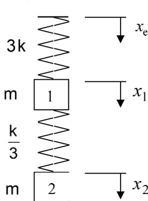
$3k$  und  $\frac{k}{3}$ ) mit periodischer Bewegung  $x_e(t) = \hat{x}_e \cos \Omega t$  des Aufhängepunkts wird die (stationäre) Bewegung des Körpers 1 bei einer bestimmten Erregerfrequenz  $\Omega = \Omega^*$  getilgt. Bestimmen Sie  $\Omega^*$  in Abhängigkeit von  $m$  und  $k$ .
