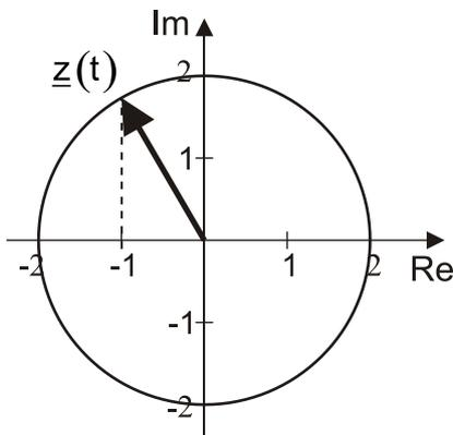
Die Amplitude  $A$  der Schwingung ist der Radius des Zeigerdiagramms. Damit ergibt sich  $A = 2$ . Der Zeiger ist dargestellt für den Zeitpunkt  $t = \frac{\pi}{\omega}$ . Daraus ergibt sich durch Einsetzen von  $t$  und Ablesen des Winkels zur reellen Achse aus der Zeichnung die Beziehung.
