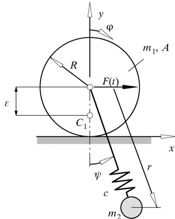
Die Bewegung soll für kleine Schwingungen um die stabile Gleichgewichtslage analysiert werden. Die Bewegungsgleichungen sind mit Hilfe der Newton-Eulerschen -Gleichungen zu ermitteln.
