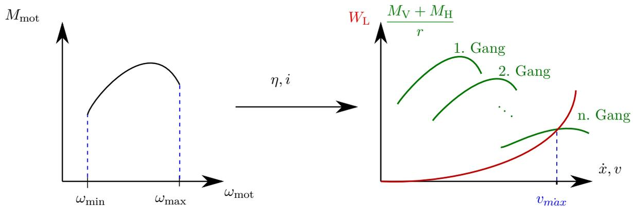
Abbildung 2: Zugkraftdiagramm
